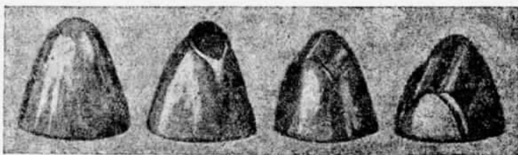
Рис. 160. Последовательные стадии снашивания иглы.
