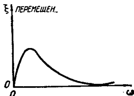
Рис. 22. Амплитудный спектр однократного явления.
