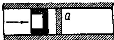
Рис. 8. Возбуждение плоской акустической волны в трубе.
