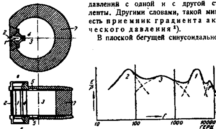
Рис. 147. Конструкция микрофона с закрытой лентой и его частотная характеристика.
