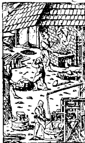
Рис. 29. Открытый горн и часть хвостового молота. Гравюра из сочинения Георгия Агриколы (XVI в.).
