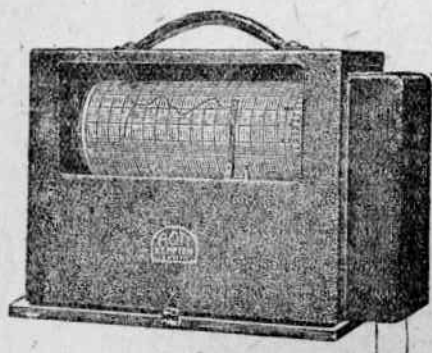
Рис. 57 и 58. Ручной лимниграф. 57—закрытый, 58—открытый
