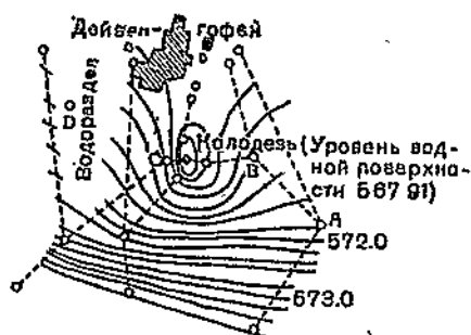
Рис. 45, 46. Расположение гидронизогин до и при откачке воды из колодца.
