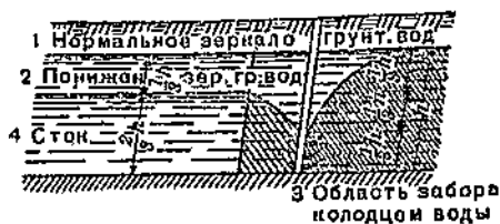
Рис. 44. Схема действия забора воды из колодца в потоке грунтовой воды.
