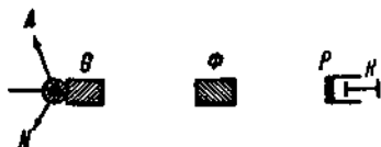
Рис. 36. Схема опытов Деннинга по исследованию поглощения нейтронов.
