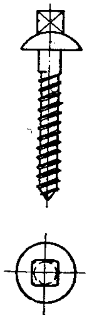
Рис. 30. Шуруп для крепления рельсов к шпалам
