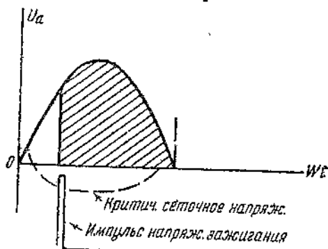
Фиг. 201. Зажигание тиратрона от импульса постоянного тока, приложенного к сетке.
