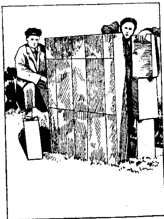
Рыс. 28. Сілікат-арганічныя будматэрыялы дапускаюць выраб буйнаблочных матэрыялаў. На рысунку—блок для сцяны размерам ў 1,50 \times 1,00 \times 0,25 м (сцяна таўшчынёю ў 25 см) і вагою каля 300 кг з механізаванай укладкай (краны). Надход да індустрыялізацыі і монтажу будовы. Рыфленая п.верхня блоку—для трымаўкі.
