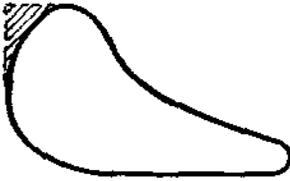
Фиг. 37. Малое предварение впуска, а в некоторых случаях даже начало впуска после выхода поршня из мертвого положения.
