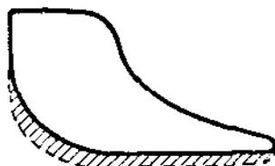
Фиг. 46. Высокое сжатие, благодаря раннему закрытию выпускного канала. Такая же диаграмма может получиться при малом давлении впуска.
