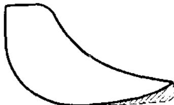
Фиг. 45. Высокое противодавление, вследствие неправильной работы конденсационного устройства или малого сечения паровыпускных каналов (паропровода).
