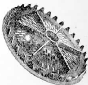
Фиг. 5. Колосниковая решетка газогенератора „Дейтц“ (вид снизу).
