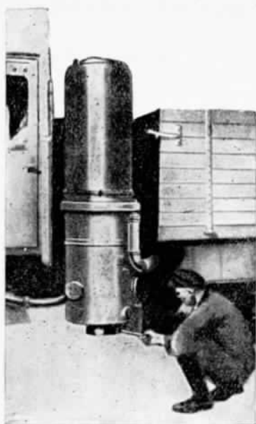
Рис. 13. Розжиг газогенератора «Дейтц».
