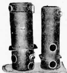
Фиг. 40. Наружный кожух газогенератора (слева) и корпус тонкого фильтра (справа) газогенераторной установки „Берлие“.
