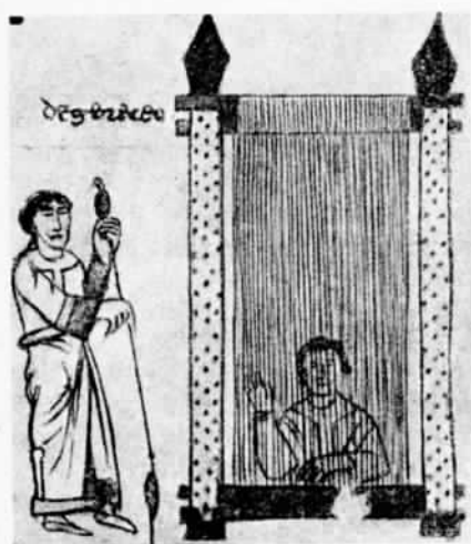
Рис. 21. Веретенное прядение и вертикальная ткацкая рама. Итальянская миниатюра 1023 г.
