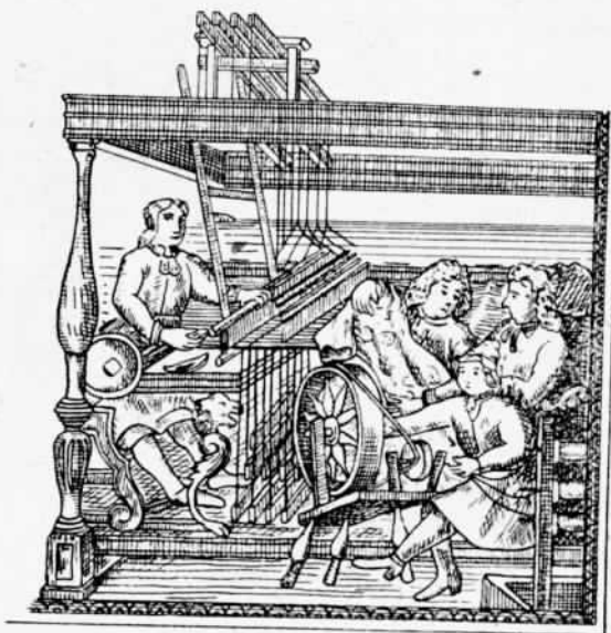
Рис. 47. Ткацкий станок для выделки широких полотен на Большой Ярославской мануфактуре середины XVIII в.
