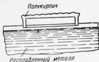
Рис. 103. Металлизация краев полукирпича
