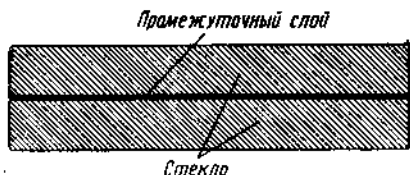
Рис. 17. Разрез стекла триплекс
