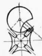
Рис. 42. Механизм мальтийского креста. (К термину 120.)
