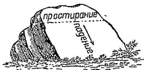
Фиг. 6. Определение положения в пространстве наклонных пластов при помощи двух линий. Из Штудера (Geologisches Kartieren und Prospektieren, 1924).
