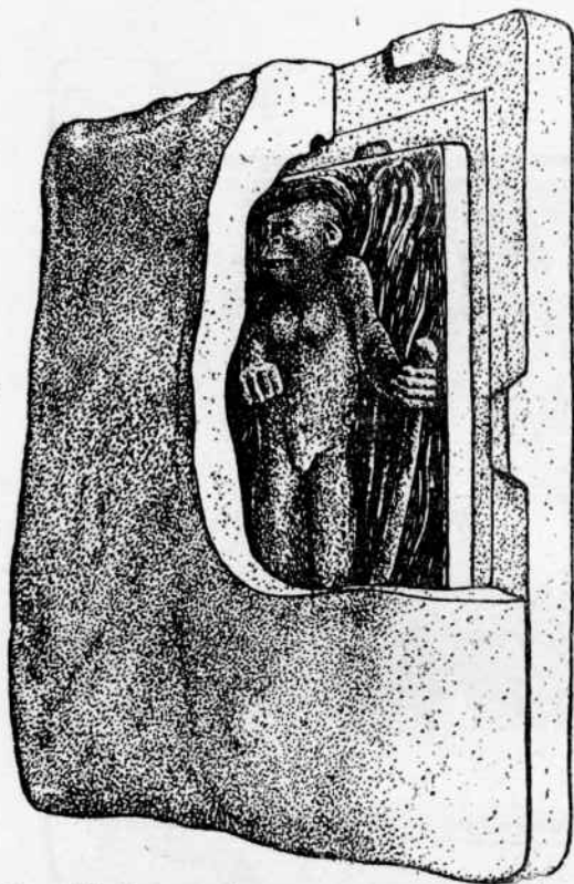
Рис. 111. Клеевая формовка сложного рельефа. Модель рельефа, накрытая кожухом.
