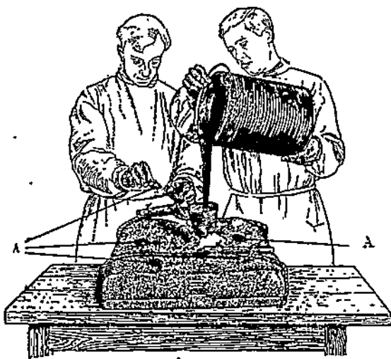
Рис. 112. Клеевая формовка сложного рельефа. Наливка клея в кожух. А — кусочки глины для закрывания отверстий при выходе из них воздуха.
