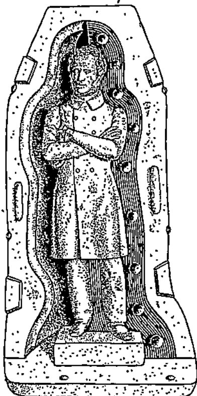
Рис. 129. Изготовление клеевой формы на круглую скульптуру. Модель и задняя половинка кожуха, установленные на плитку; с правой стороны, пустота между моделью и кожухом заполнена глиной, т. е. «вымазана усенка»; на последней сделано несколько выпуклых замков.
