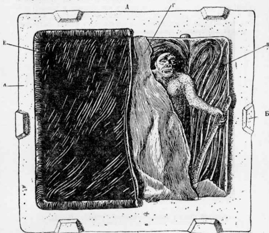
Рис. 109. Клеевая формовка сложного рельефа. Изготовление кожуха. А — гипсовая плита (фон, грунт), Б — замки, В — модель, Г — бумага, Д — глиняный пласт, Е — глиняный валик.
