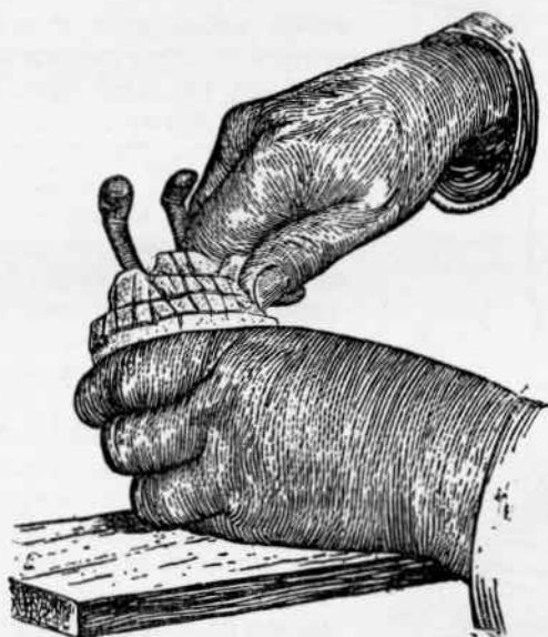
Рис. 64. Расколотка приборов и мелких отливок. Кончик ножа на рисунке не виден.
