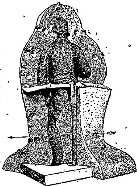
Рис. 15. Показано разделение задней раковины на три части, в том случае, когда каркас близко расположен к оригиналу. Стрелки показывают, в какую сторону каждая из раковин отнимается.
