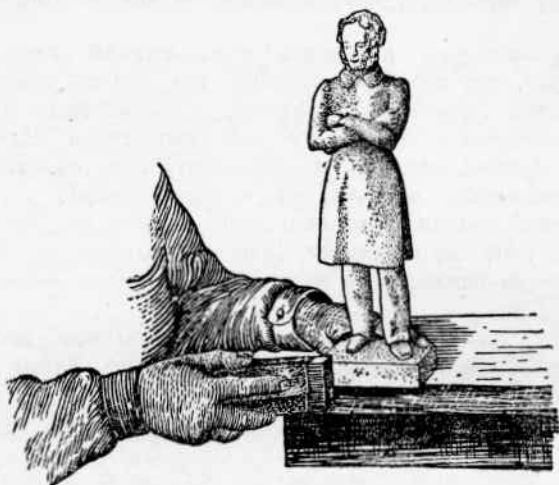
Рис. 205. Прошкуривание ровных плоскостей.
