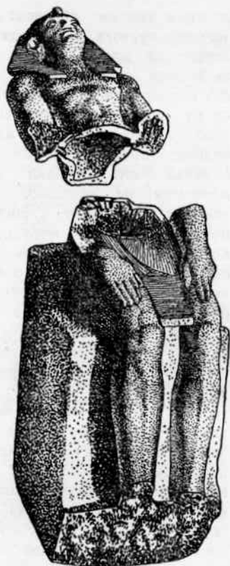
Рис. 208. Соединение крупных полых отливок. Стычки нарезаны и подготовлены для накладки гипса.
