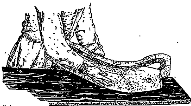
Рис. 33. Складывание половинок подлитой формы.
