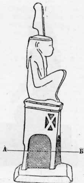
Рис. 168. Устройство „стенки“ на модели. Часть модели сбоку. Заштрихованные места представляют собой сделанные пустоты — „стенки“.
