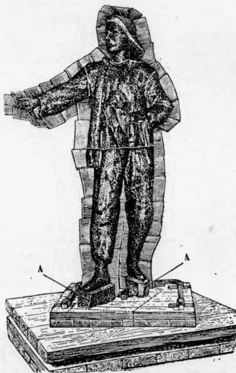
Рис. 173. Черновая формовка большой статуи для отливки из бронзы. Подготовка к окатке цветным слоем гипса. На рисунке показана разбивка статуи на отдельные части. А — „калоши“. На щите пунктиром показаны границы уничтоженного плинта.
