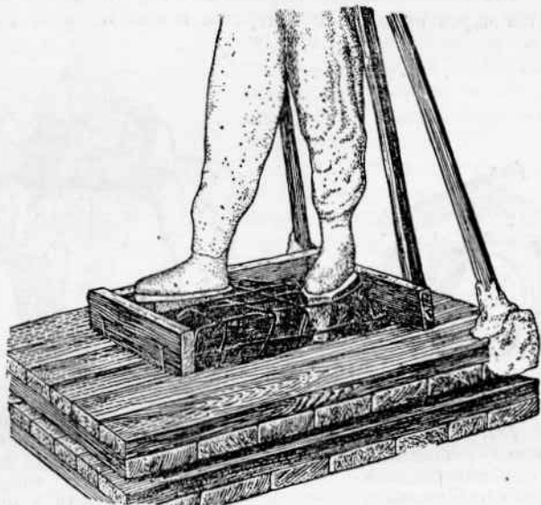
Рис. 189. Черновая формовка большой статуи для отливки из бронзы. Подготовка к наливке плинта. Одна из стенок убрана, чтобы показать внутренний вид сбоку.
