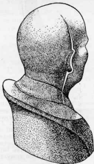
Рис. 170. Отливка с заскоком. Задняя половинка отливка запала внутрь относительно передней.
