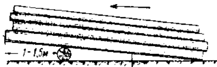
Рис. 198. Укладка древесины на лесосеке при тракторной трелевке пнями.
