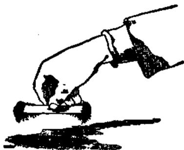
Рис. 31. Магнитные полюса.—Если магнитный брусок опустить в железные опилки и затем поднять, как показано на рисунке, то оказывается, что опилки пристанут к его обоим концам, но не к середине. Концы бруска называются полюсами магнита.
