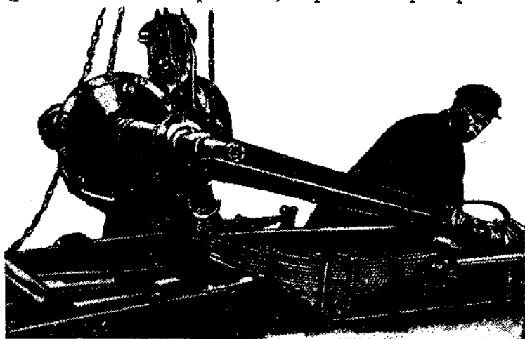
Фиг. 112. Установка заднего моста на кантилеверные рессоры
