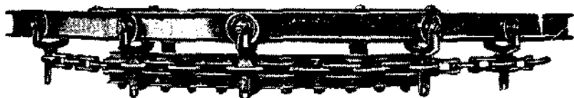
Фиг. 11. Ролевой трек закругления конвейера
