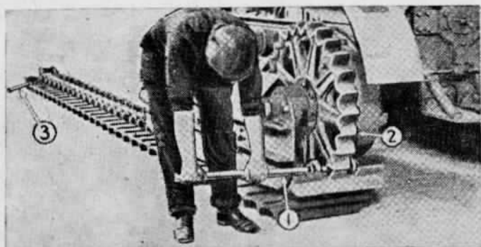
Фиг. 135. Начало установки гусеничного полотна на трактор
