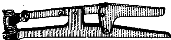
Фиг. 79. Приспособление для сжатия клапанной пружины
