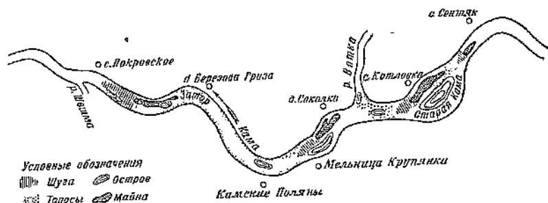
Фиг. 54. План ледяного покрова р. Камы в районе г. Чистополя по маршрутным обследованиям в марте 1953 г.
