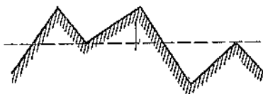
Фиг. 49. Схема, иллюстрирующая характер шероховатости.
