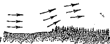
Фиг. 2. Схема восходящих токов при движении воздуха над лесом.
