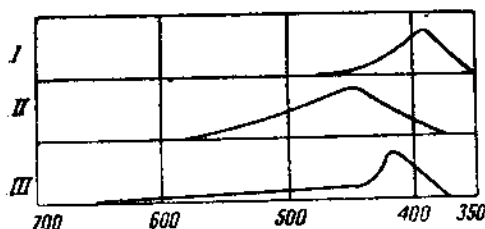
Рис. 62. Сравнительная цветоочувствительность галоидных солей серебра: I—хлоридное серебро, II—бромидное серебро, III—иодидное серебро.
