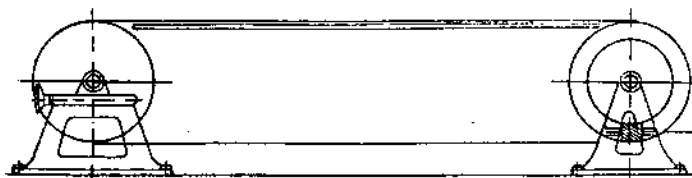
Рис. 69. Схема ленточной машины для изготовления пленки (основы).
