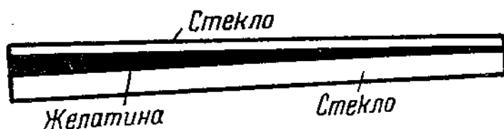
Рис. 20. Схема нейтрально-серого клина Гольдберга (в разрезе)
