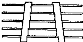
Рис. 2. Схема подвески плит на впадинах лир.
