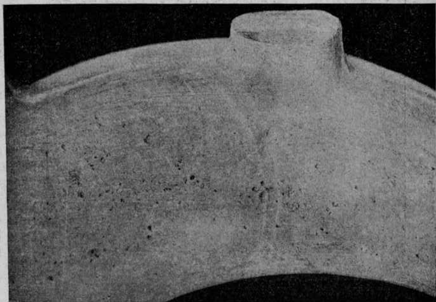
Фиг. 93. Фотография отливки с шлаком.
