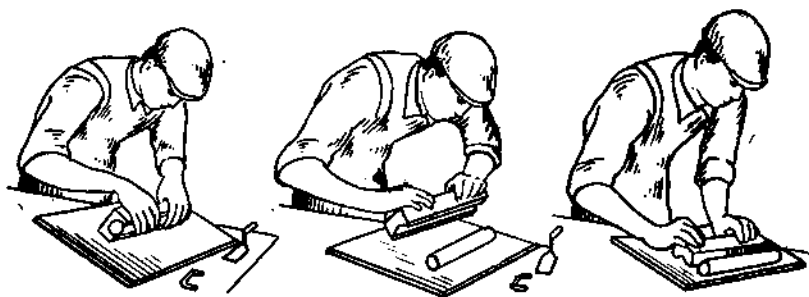
Фиг. 64. Освобождение стержня из ящика.
