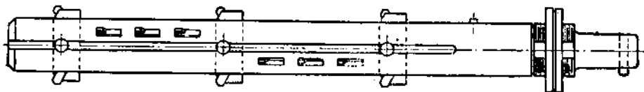
Рис. 204. Оправка с тремя блоками Дэвис.
