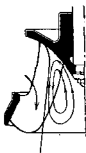
Фиг. 141. Наблюдаемое обратное течение в турбине Френсиса
