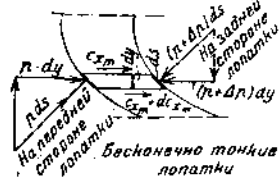
Фиг. 43. Подсчет разности давлений в канале лопаток.
