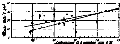
Рис. 15—Зависимость потерь серы в газовой фазе (г/м³) от содержания кислорода в исходном газе
