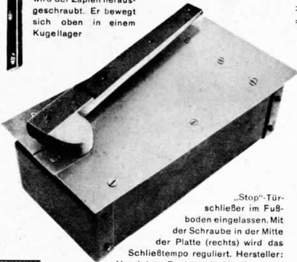
„Stop“-Türschließer im Fußboden eingelassen. Mit der Schraube in der Mitte der Platte (rechts) wird das Schließtempo reguliert. Hersteller: Vereinigte Baubeschlagfabriken Gretsch & Co., G. m. b. H., Stuttgart-Feuerbach
