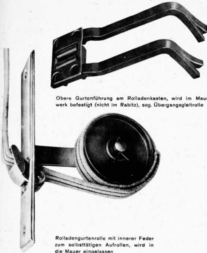
Obere Gurtenführung am Rolladenkasten, wird im Mauerwerk befestigt (nicht im Rabitz), sog. Übergangsgleitrolle
