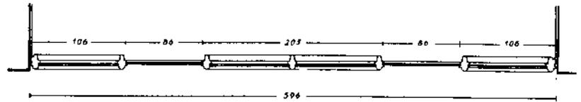
Die für diese Glaswand verwendeten Holzrahmen sind im Querschnitt schmal und tief und außerdem noch profiliert, damit bei größter Stabilität der Eindruck der Leichtigkeit erreicht wird.
