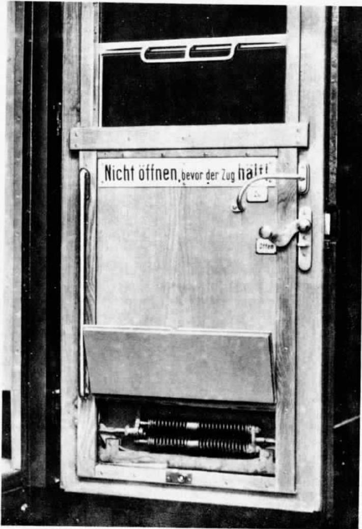
Offene Türe mit herabgelassenem Fenster. Unten kleine Klapptüre zur Kontrolle des Fensterhebers
