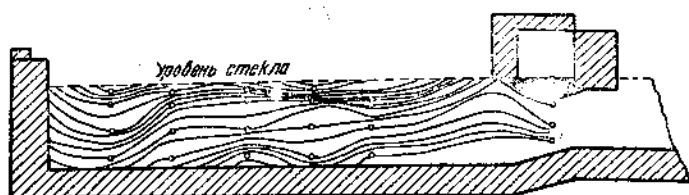
Рис. 16. Изотермы в стекломассе (центральная продольная линия).
