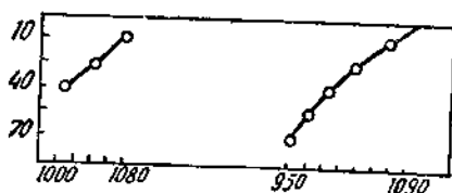
Рис. 26. Распределение температур в стекломассе подогревательной камеры маш. № 4.
