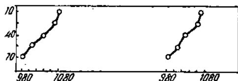
Рис. 24. Распределение температур в глубине стекломассы подогревательной камеры маш. № 2.
