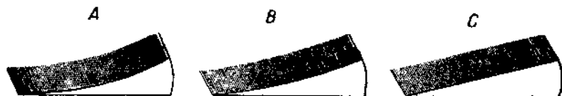
Рис. 106. Сечения бритв и ножей автоматического микротомы: А — для мягких срезов, В — для препаратов средней твердости, С — для жестких срезов.
