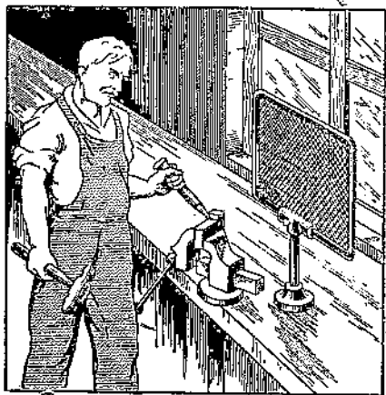
Фиг. 31. Слесарный верстак с предохранительным щитком.
