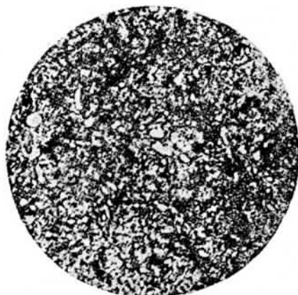
Фиг. 179. Микроструктура стали, отпущенной на 575°
