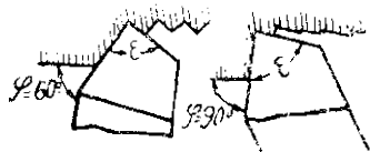
Фиг. 43. Остаточные гребешки при разных углах в плане
