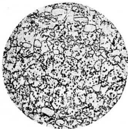
Фиг. 180. Микроструктура стали, закаленной на аустенит (при 1175°)
