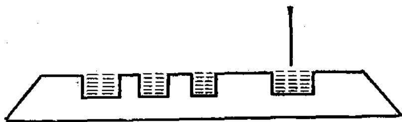
Рис. 19. Схема глубокой печати. Пунктиром указана краска.
