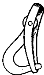
Рис. 145. Безопасный крюк с зам- ком.
