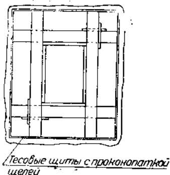
Рис. 142. Схема паровой рубашки для колонны.
