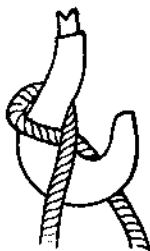
Рис. 144. Надевание крюка на канат.
