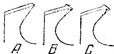
Рис. 106. Видоизменение зуба при расклепывании и формовке.
