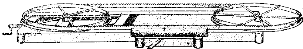
Рис. 112. Прибор для закрепления ленточных пил при отточке и разводе зубьев.
