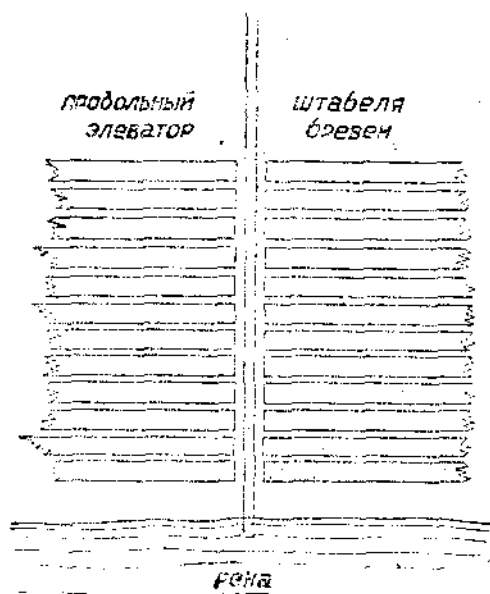
Рис. 127. Схема расположения штабелей при выгрузке продольным элеватором.
