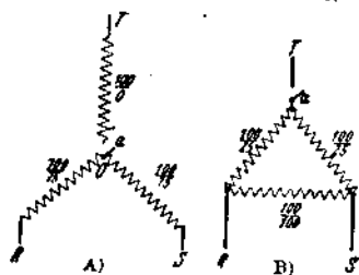
Рис. 57. Переключение со 100 на 50% мощности.
