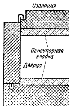
Рис. 129. Уплотнение дверцы песочными запорами (сверху и снизу).
