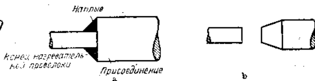
Рис. 88. Сварное соединение круглой проволоки с соединительным куском.
