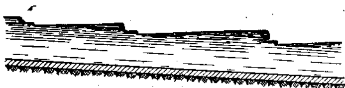
Рис. 34. Схема набегающих по длине потока друг на друга волн при движении осадка с небольшими скоростями.
