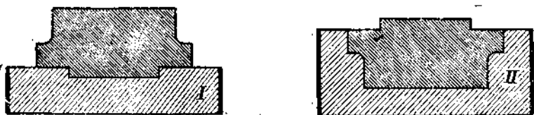
Рис. 84. Формовка с фальшивой опокой.
