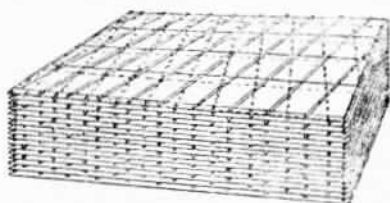
Рис. 101. Решетки из алюминия. Схема, показывающая расположение решеток и шпона
