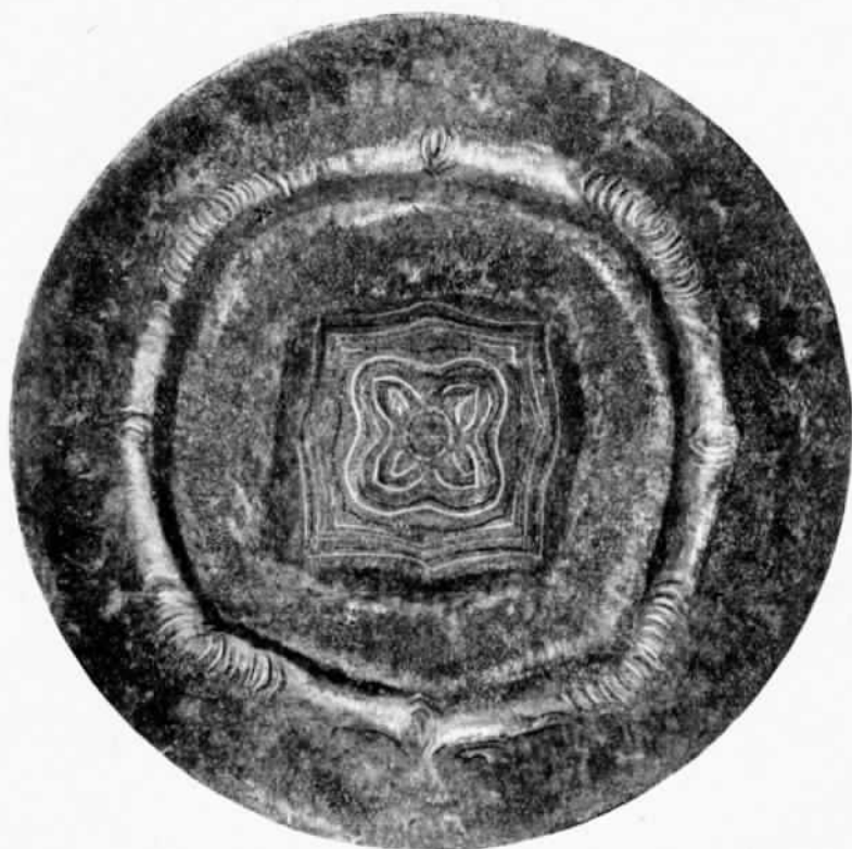
Рис. 127. Декоративная фанера для круглого стола, составленная из восьми отдельных кусков шпона
