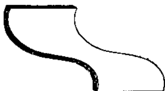
Рис. 17. Театральное сиденье из пятислойной переклейки. Волокна верхнего и нижнего слоев, также и серединки, параллельны, в то время как находящиеся между ними шпоны уложены в поперечном направлении
