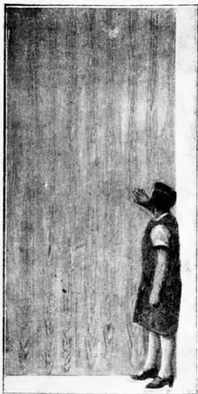
Рис. 90. Столярная плита, составленная из ножевого соснового шпона. Размер плиты 1,5 × 4,5 м
