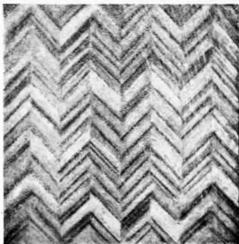
Рис. 6а. Декоративная фанера из полос, раскrojенных по диагонали
