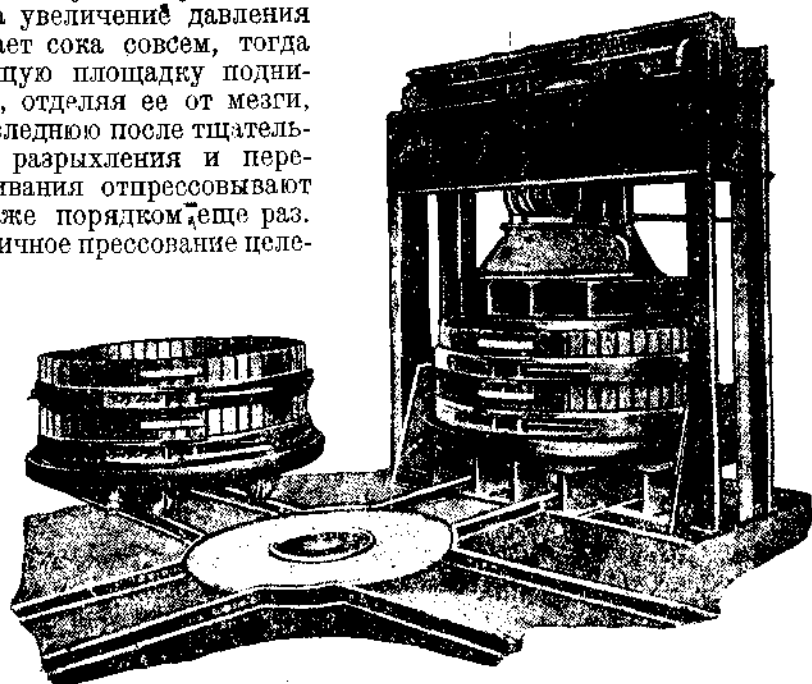
Рис. 9. Гидравлический пресс с 2 чашками-вагонетками.
