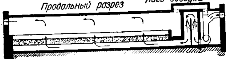
Канал рециркуляции ного воздуха
