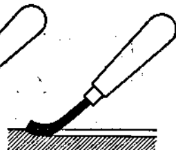
Рис. 163. Изогнутый круглый напильник для сглаживания смазочных канавок в бронзовых вкладышах.
