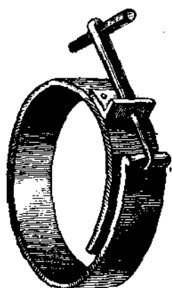
Рис. 248. Приспособление для сжатия поршневых колец при установке поршня в цилиндр.
