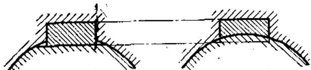
Рис. 108. Получение фрикционной шпонки из заготовки клиновидной низкой шпонки.
