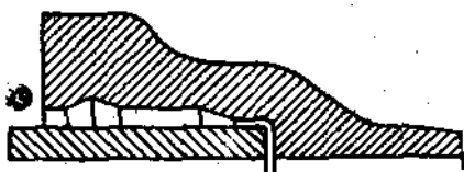
Рис. 251. Чугунная труба с раструбным соединением.
