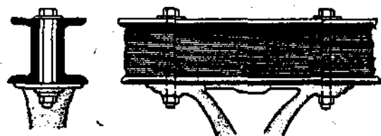
Рис. 191. Укрепление подвески на двух швеллерных балках вдоль балок.
