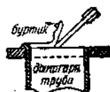
Срубка бортов трубы
