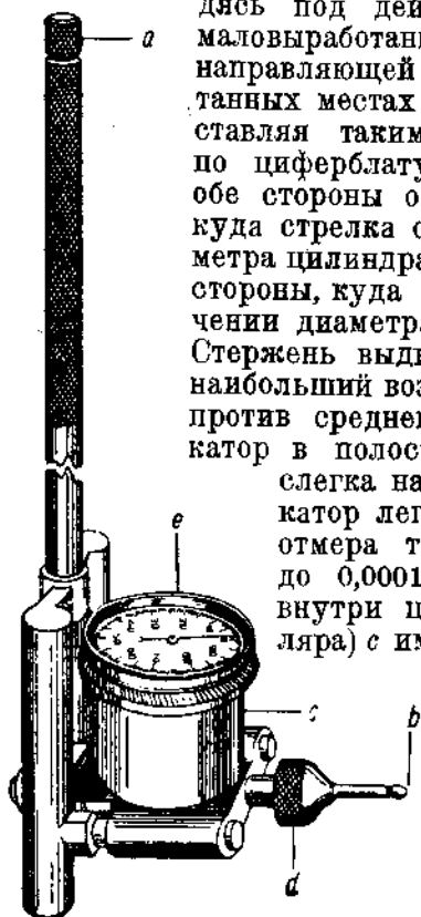
Рис. 9. Общий вид индикатора «Старрет» для измерения износа цилиндров.
