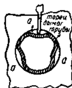
Снятие конца трубы
