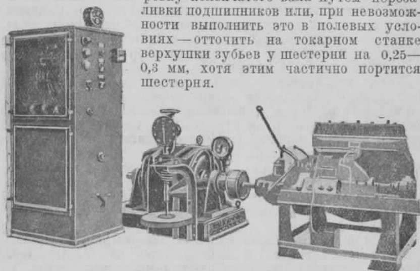
Рис. 60. Установка для испытания двигателя.
