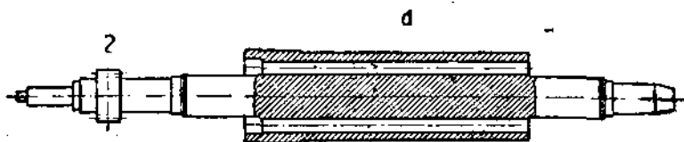
Фиг. 13. Барабаны реактивных турбин.
