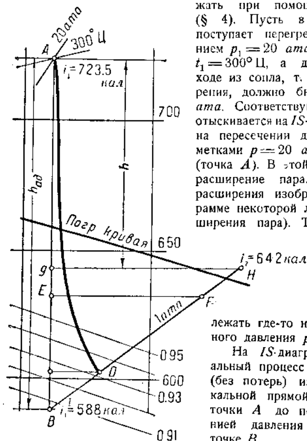
Фиг. 4. Изображение теплового процесса активной турбины в IS -диаграмме.
