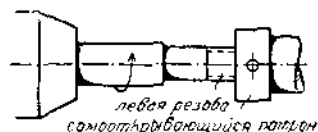
Рис. 62. Нарезание левой резьбы самооткрывающимся винторезным патроном. Изделие: медленный левый ход. Винторезный патрон: не вращается.
