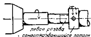
Рис. 54. Нарезание левой резьбы самооткрывающимся резьбовым патроном. Изделие: быстрый правый ход. Винторезный патрон: более быстрый правый ход.
