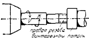
Рис. 63. Нарезание правой резьбы. Изделие: медленный правый ход (вперед), быстрый левый ход (назад). Винторезный патрон: не вращается.
