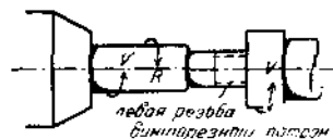
Рис. 58. Нарезание левой резьбы. Изделие: быстрый левый ход (вперед), быстрый правый ход (назад). Винторезный патрон: немного замедленный левый ход (вперед). При обратном ходе не вращается.
