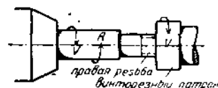
Рис. 57. Нарезание правой резьбы. Изделие: быстрый правый ход (вперед), быстрый левый ход (назад). Винторезный патрон: немного замедленный правый ход (вперед). При обратном ходе не вращается.
