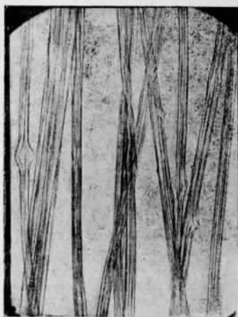
Рис. 93. Микроскопическое изображение волокон искусственного шелка
