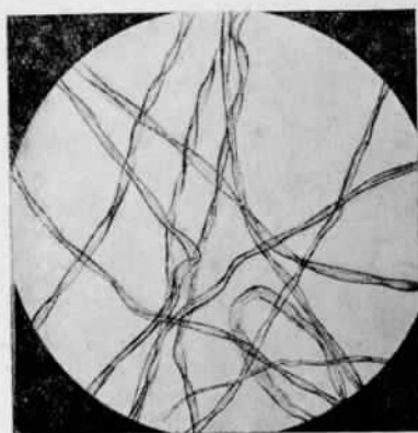
Рис. 80. Микроскопическое изображение волокон хлопка
