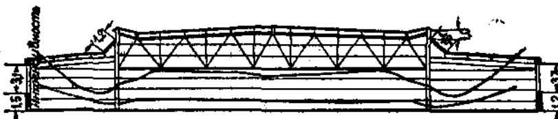
Фиг. 36. Кривые распределения дневного света в зависимости от увеличения площади окон в фонаре и применения комбинированных окон.
