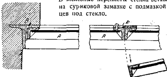
В —закладная рама, А —створная рама, Р —пластинка, прикрепленная к средней обвязке. Черт. 259
