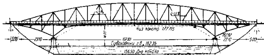
Фиг. 128. Схема консольного моста с выпуклым очертанием верхнего пояса
