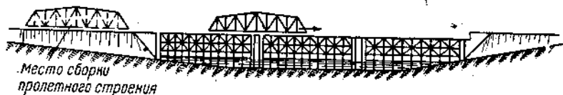
Фиг. 356. Продольная надвигка пролетного строения по сплошным подмостям
