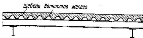
Фиг. 64. Проезжая часть с нижним строением из волнистого железа
