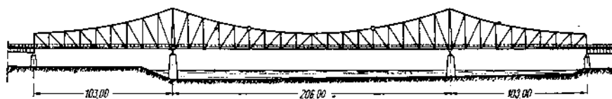
Фиг. 127. Схема консольного моста с ездой по низу
