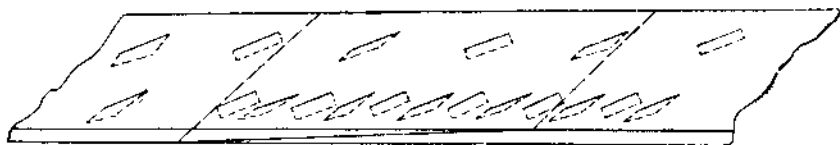
Рис. 53. Направление дыр в ремне для сшивки кожей.
