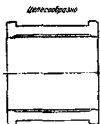
Фиг. 9. Нагруженный вкладыш с обычными смазочными канавками.
