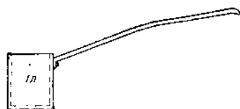
Фиг. 42. Ковш для взятия средней пробы масел
