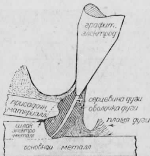
Рис. 14. Диаграмма сварочной дуги.
